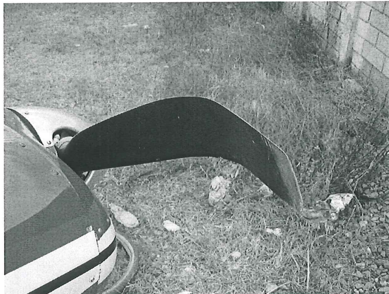
La hélice del lado derecho sufrió destrucción al topar con el montículo de arena y piedras.
