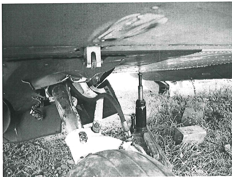
Vista de los daños en el tren principal del lado izquierdo
