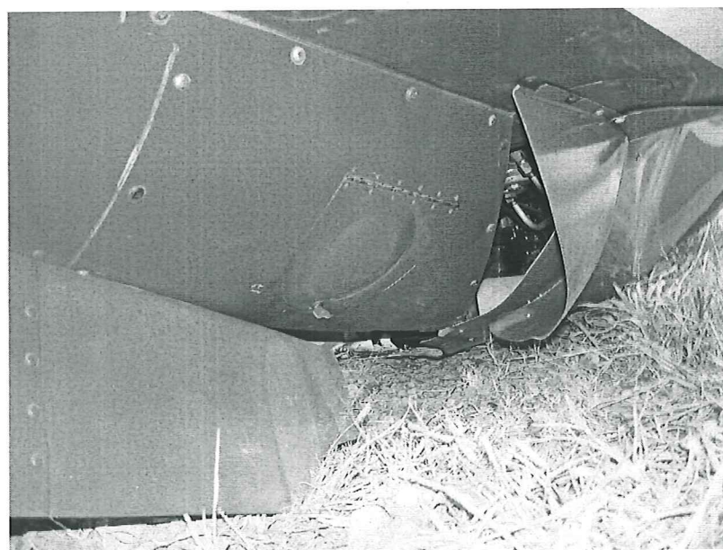
Daños en los cobertores metálicos del motor del lado izquierdo
