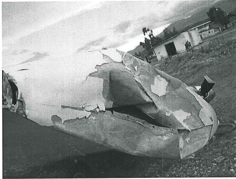
Vista directa del área dañada de la punta del ala
