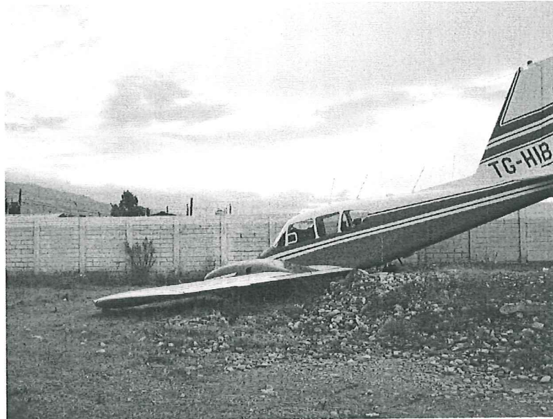
La estructura de la aeronave no sufrió mayor daño .
