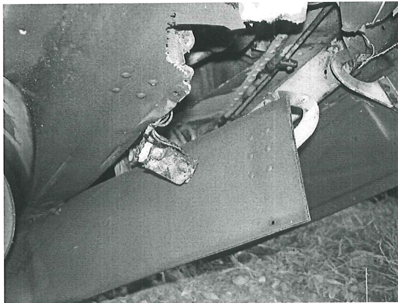
Vista de los daños en el tren de aterrizaje de nariz
